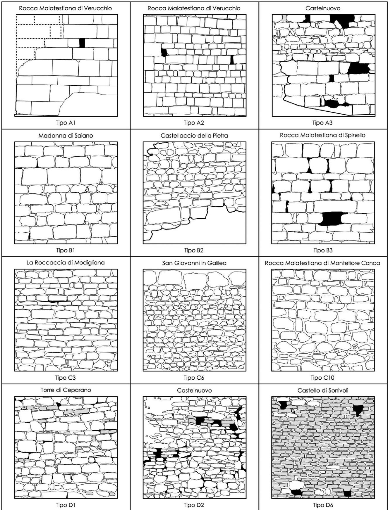
fig. 6 – I principali tipi di murature dei castelli della Romagna (campioni di 2×2 m): A. Con elementi “da scalpellino”, riquadrati oppure squadrati tramite attenta sbazzatura; B. Con elementi “da sbazzatore”, squadrati tramite sbazzatura sommaria; C. Con elementi “da muratore”, non lavorati o al massimo spaccati; D. Con elementi misti (litici e laterizi).
