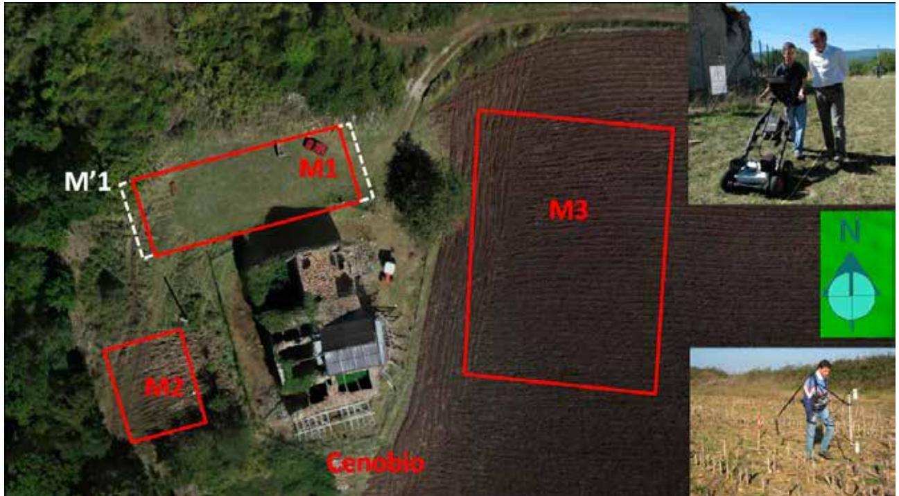
una magnetizzazione propria. Le misure sono state acquisite con magnetometro G-858, utilizzato in configurazione gradiometrica, con i due sensori disposti ai vertici di una staffa verticale, al fine di ottenere contemporaneamente tre mappe, due per i singoli sensori ed una terza relativa al gradiente verticale.
